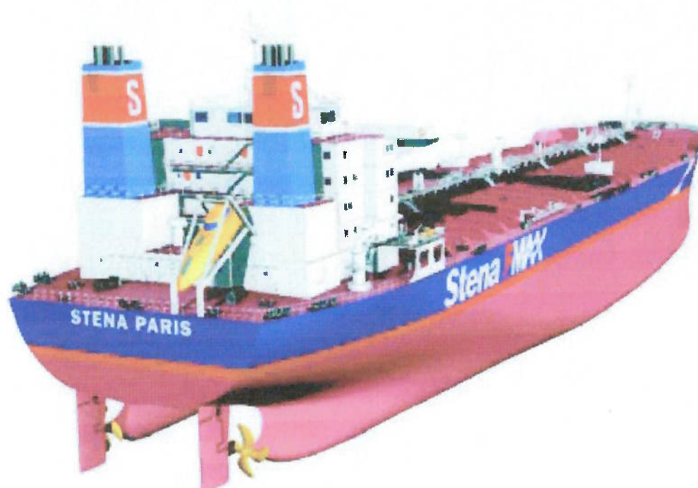
Figura 3.1: Foto do petroleiro encomendado pela Stena com dois propulsores.
