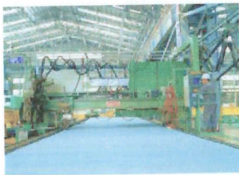
Figura 6.6: Máquina de corte DNC pertencente ao Hyundai.
