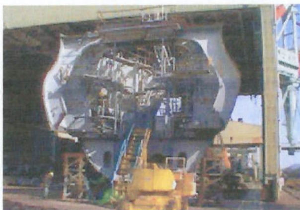
Figura 7.6: Colocação dos equipamentos em blocos.
