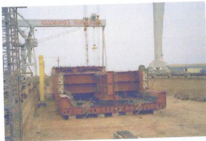
Figura 7.8: Construção em um dique seco.
